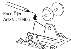
Ca. alle 30 Betriebsstunden! • I.e. after it has been in operation for 30 hours! • Environ tous les 30 heures d'exploitation! • Na elke 30 diensturen!
